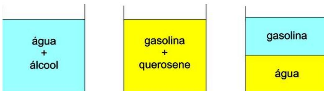
Tanto o álcool quanto a água, são polares. Logo, a mistura entre eles, forma uma única fase. Já a gasolina e o querosene, são ambos apolares. Ou seja, ao misturar os dois, temos também uma única fase. Mas ao pegarmos gasolina (apolar) com água (polar), temos então as duas fases bem aparente, isso ocorreu porque eles não são semelhantes, não apresentam a mesma polaridade.
